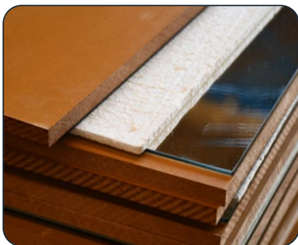
colocação de isopor entre as peças
